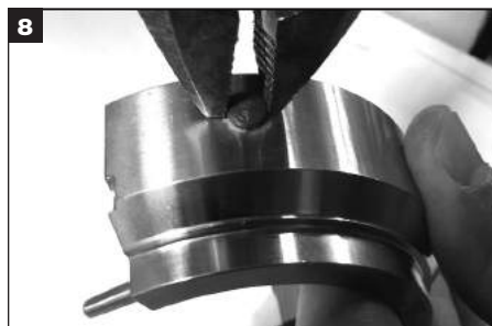
8 Fjern brukte sentreringsknapper på den ytre diameteren til roterende klamme.
