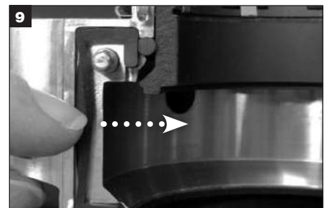
9 Fjern brukte glandpakninger fra glandslisser.
