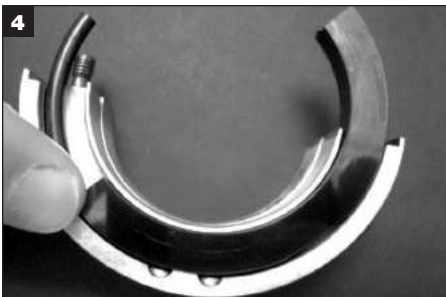
4 Fjern brukte roterende flatehalvdeler ved å trykke på enden av flaten og å la dem gli ut av roterende klammehalvdel.
